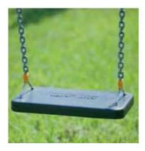
Seggiolino piano omologato, in gomma antitrauma ad "assorbimento urto", con anima interna in acciaio prestampato, sorretto da catene zincate a maglia stretta, movimento su boccole in teflon lubrificanti. Dimensioni cm. 37x20
